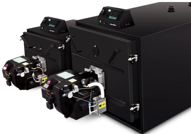
**Котлы на отработанном масле DanVex** представляют собой водотрубные автоматические герметизированные котлы, присоединяемые к дымоходу, снабженные блочной горелкой, использующей жидкое топливо, имеющие горизонтальную инверсионную камеру сгорания и пучок концентрически расположенных дымогарных труб. Котел полностью адаптирован для эксплуатации в российских условиях.
