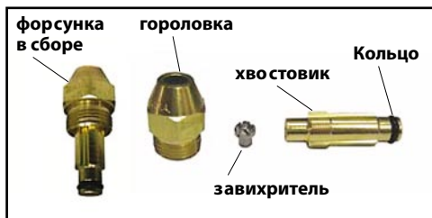
форсуночный блок
